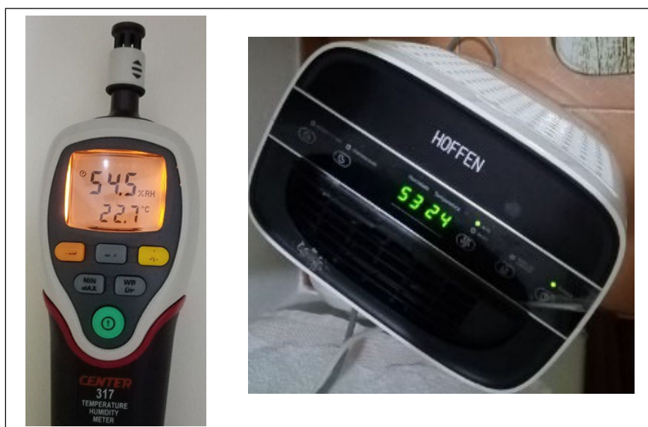
Figura 1. Registo de dados no termohigrómetro digital e no desumidificador.
