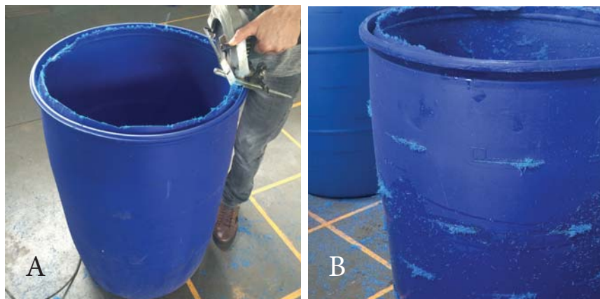
Figura 1. (A) e (B) Corte dos tambores para montagem do sistema de produção de hortaliças vertical.
