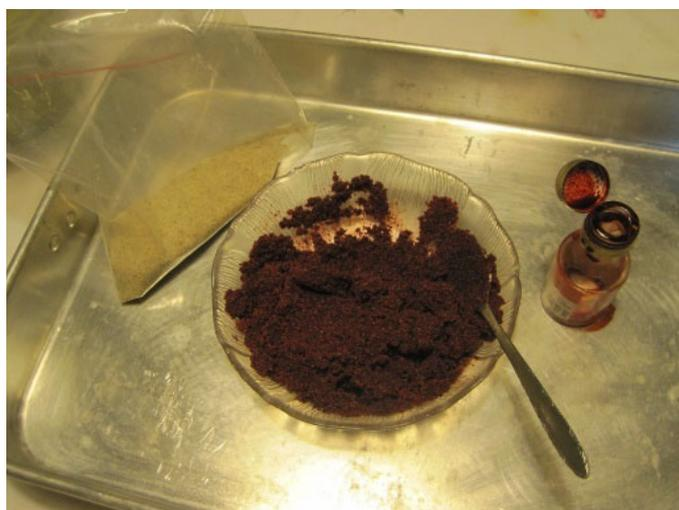
**Figura 4.** Aplicação de corante a uma das amostras de areia.
