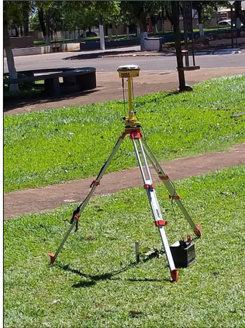
Figura 7. Posicionamento da base RTK.
