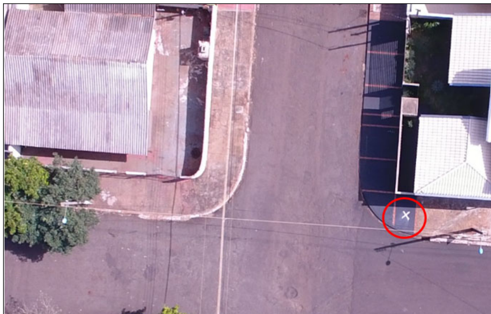
Figura 8. Demarcação dos pontos de apoio com cruzetas em cal branco.
